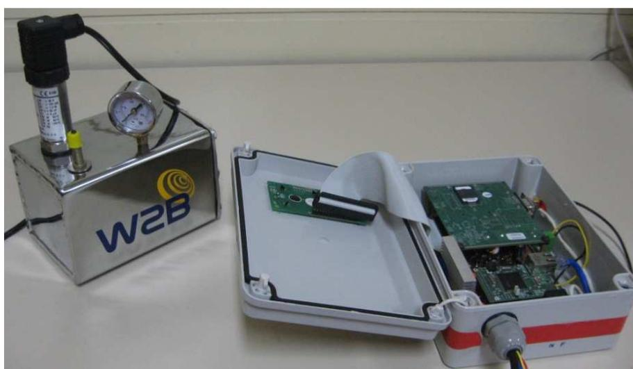
Figura 3 – Protótipo do módulo de monitoração com o transdutor de pressão acoplado a caixa blindada.
