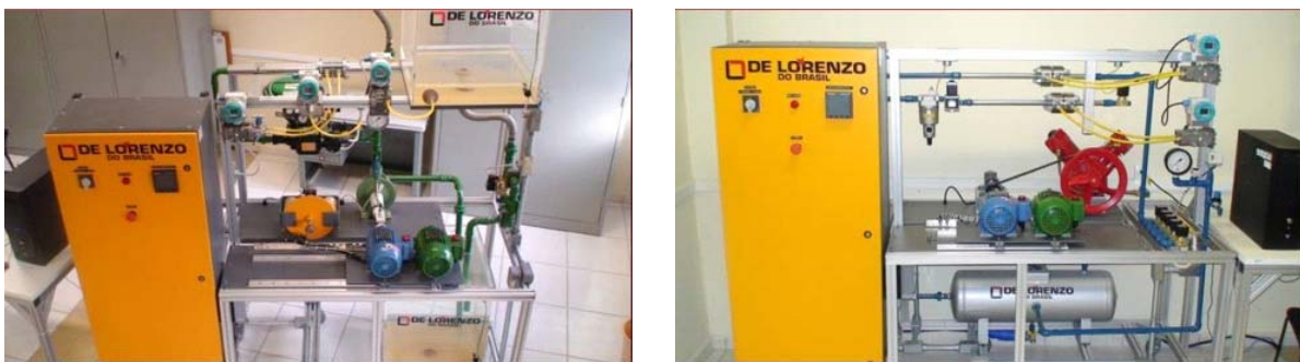
Figura 8. Bancada de Simulação: Bomba Centrífuga e Compressor de Ar
