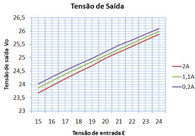
Figura 15. Valores obtidos da simulação para tensão média de saída em função da tensão de entrada
