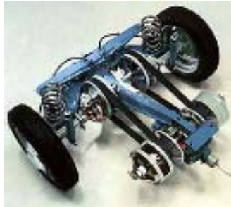
Figura 2 O eixo traseiro do DAF 55 e seu câmbio de variação contínua, com uma correia por lado
