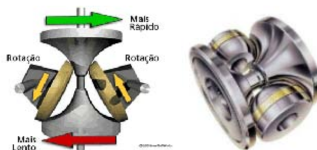
Figura 5 Esquema da transmissão Toroidal
