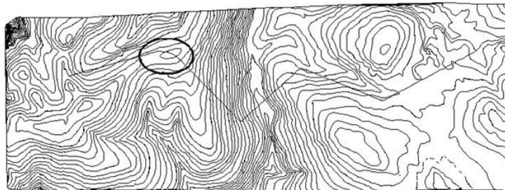
**Fig. 3 – Traçado horizontal após a definição da primeira curva.**
