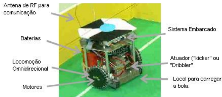
Figura 4 – Modelo comum dos robôs da Liga F-180
