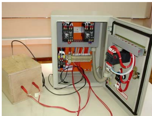
Figura 14 – Sistema de controle de temperatura
