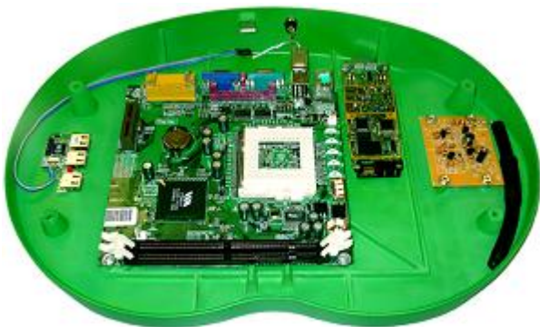
Figura 10 – hardware do e-cipó (vista interna)
