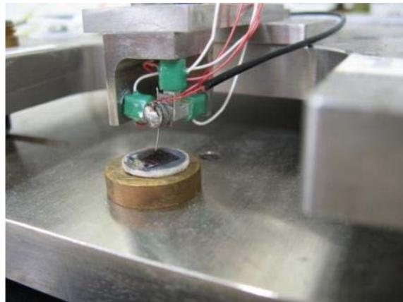
Figura 2 – Estrutura do STM com 3 cerâmicas piezelétricas do tipo Stack instaladas.
