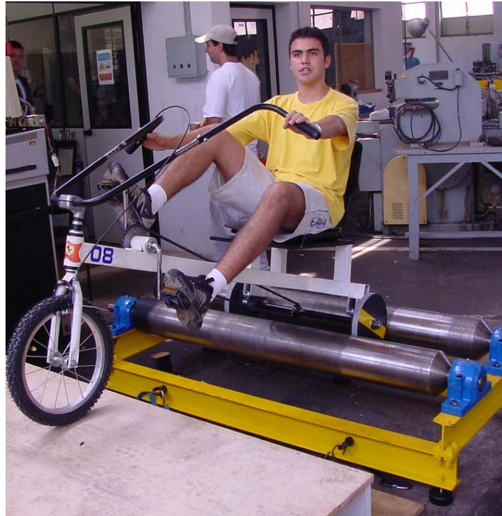
Figura 4 – Teste do triciclo em dinamômetro, após a montagem
