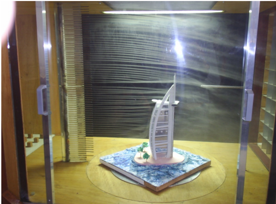
Figura 2 – Experimento em Túnel de Vento com cortina de fumaça.
