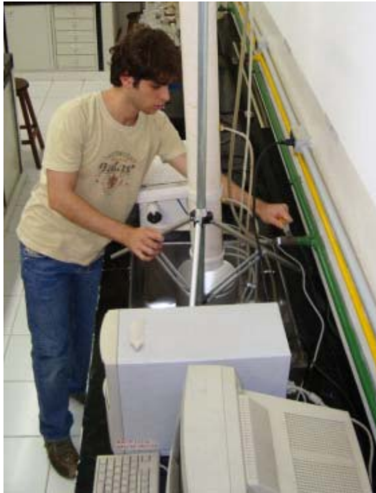
Figura 2 – Primeiro autor ajustando a coluna de calibragem para simular uma intensidade pluviométrica específica.
