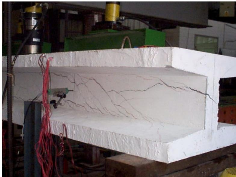
Figura 10 Fissuras na alma do lado tracionado
