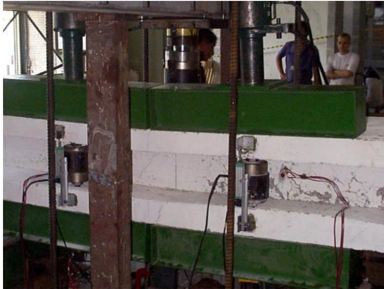
Figura 12 Ruptura por esmagamento do concreto
