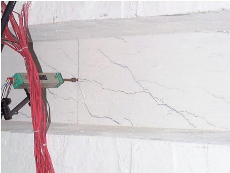
Figura 8 Fissuras abertas na alma da viga devido à carga vertical ( $P$ )
