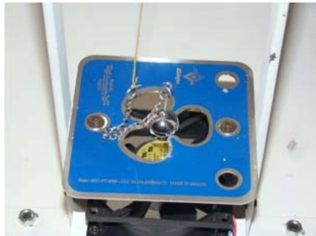
Figura 4b – Após do aquecimento a esfera não passa o orifício metálico.
