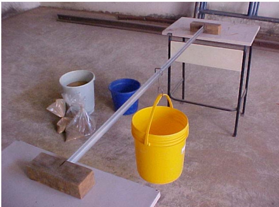
Figura 9 – Perfil preparado para ensaio (“T” invertido).
