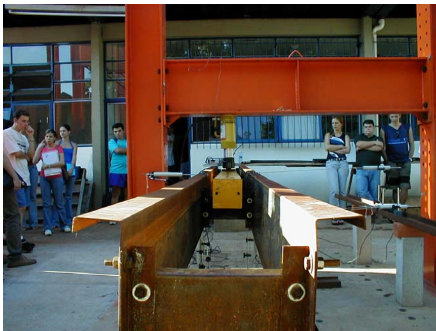
Figura 6 – Ensaio de flexão em perfis tipo U enrijecido assistido por alunos.
