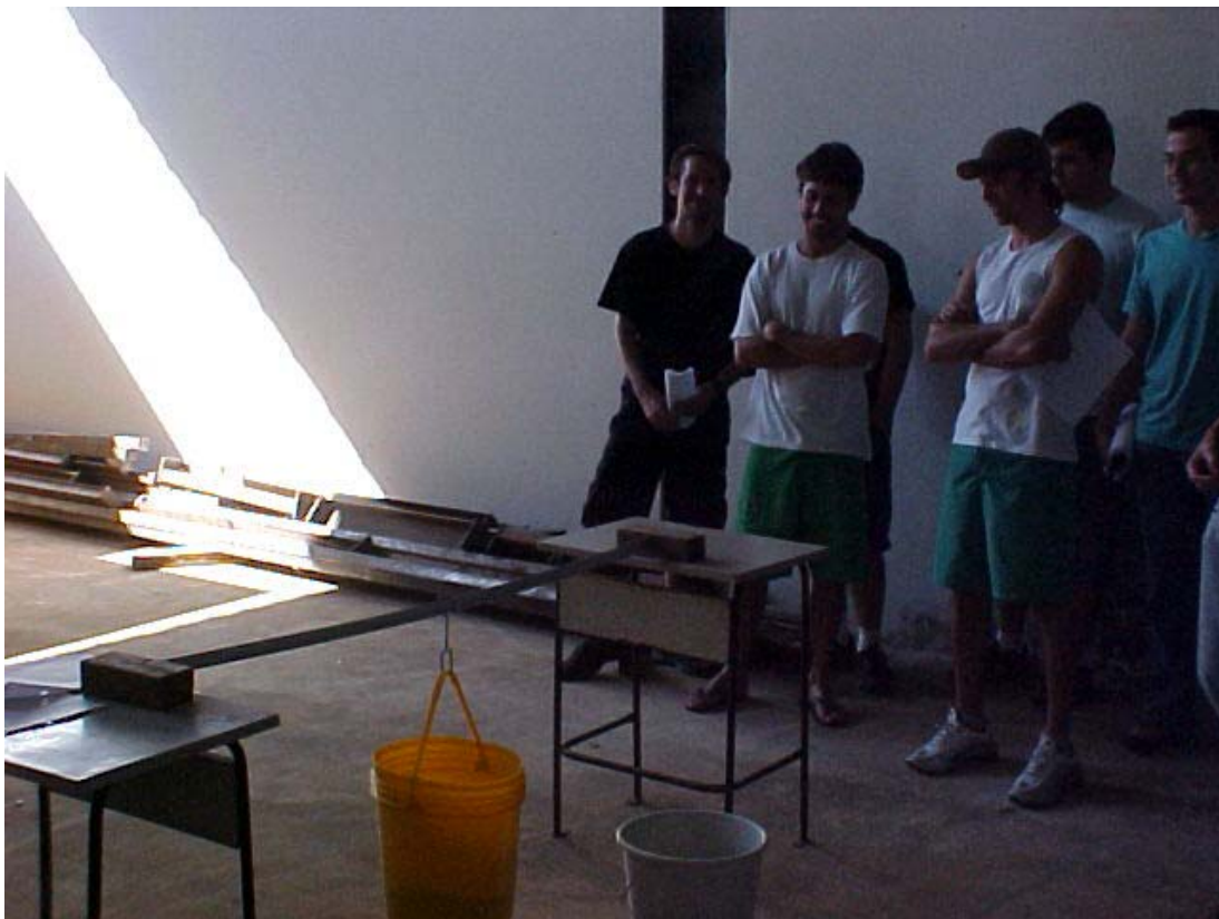
Figura 10 – Falha do perfil ensaiado com a mesa tracionada.
