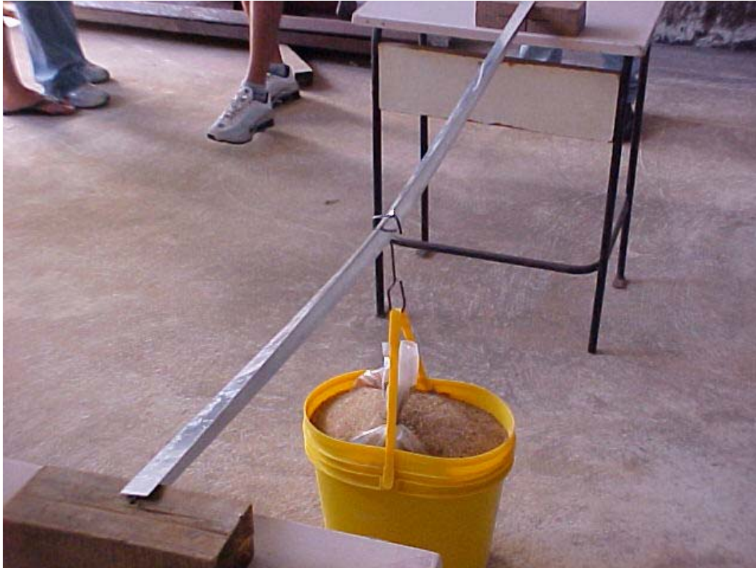
Figura 10 – Falha do perfil ensaiado com a mesa comprimida.
