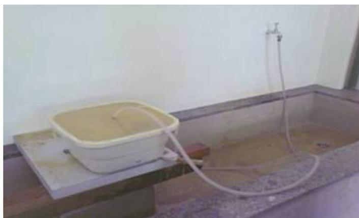
Figura 4: Simulação do fluxo ascendente em recipiente com brita e areia fina.
