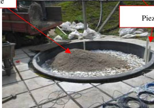
Figura 10: Fotos da seqüência da disposição das tubulações e colocação dos materiais filtrantes.
