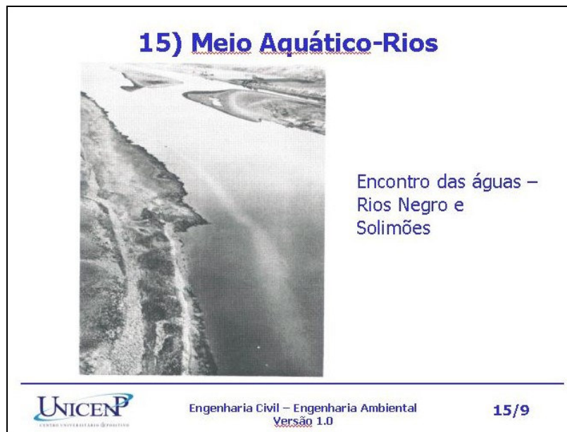
Figura 3 – Foto exemplificando o processo dispersivo conhecido como comprimento de mistura
