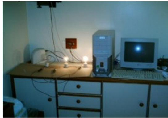
Figura 17 (b)– O Experimento real controlado pelo objeto de aprendizagem. Duas lâmpadas em série
