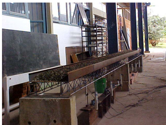
a) Carregamento uniformemente distribuído.
