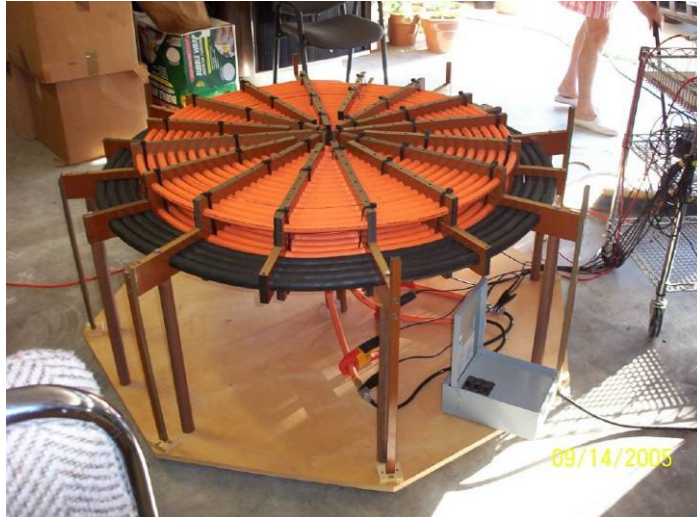
Figura 3 – Indutores de alta tensão.
