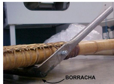
Figura 2 – Esquema do freio para carrinho de rolimã
