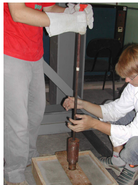
Figura 3 - Ensaio de Resistência ao impacto.
