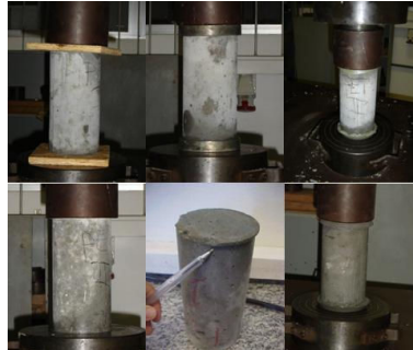
Figura 5 – Ensaio realizado com diferentes tipos de capeamento
