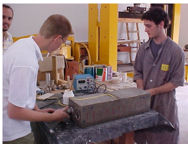
Figura 1 - Execução de experimentos: ultra-som para avaliar a resistência do concreto.
