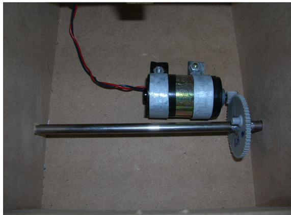
Figura 3 – Sistema do motor CC com sua redução.
