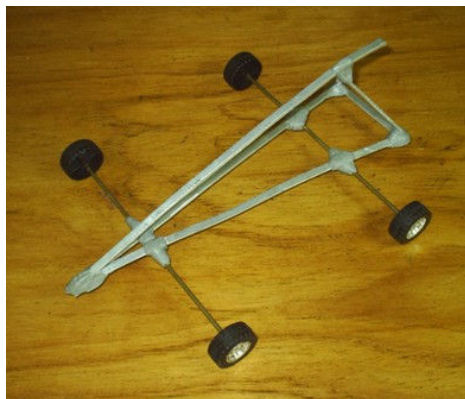
Figura 2 – Exemplo de protótipo com o conceito de estrutura triangular.
