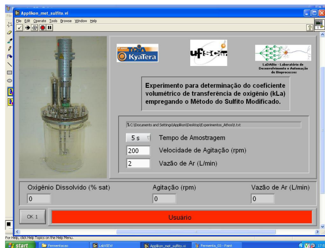
Figura 4. Primeira tela apresentada ao usuário. Nesta tela definem-se o nome do arquivo para gravação dos dados experimentais, o intervalo de aquisição e o valor das variáveis velocidade de agitação e vazão de ar.
