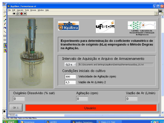
Figura 7. Primeira tela do experimento de determinação de k_{La} pelo método degrau na velocidade de agitação.
