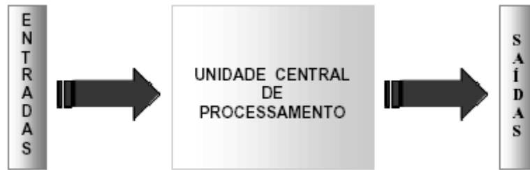
Figura 1 : Estrutura básica de um CLP
