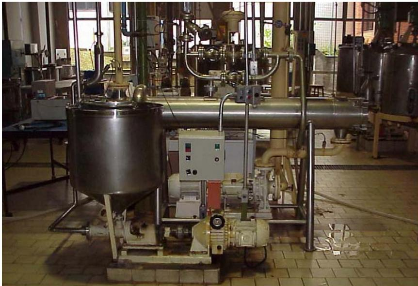
Figura 1 – Trocador de calor feixe tubular.
