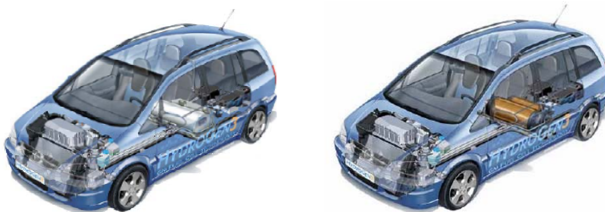
GM/Opel HydroGen3 com armazenamento de hidrogênio líquido (a direita) e comprimido (a esquerda).
