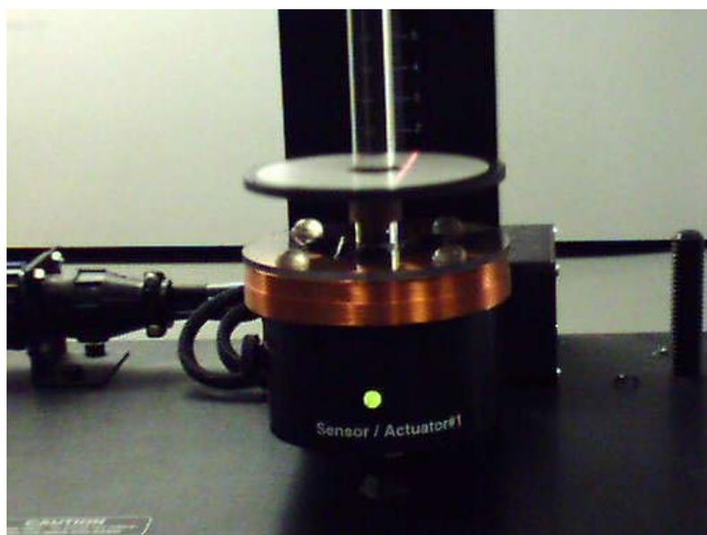
Figura 7 - Levitador magnético operando.
