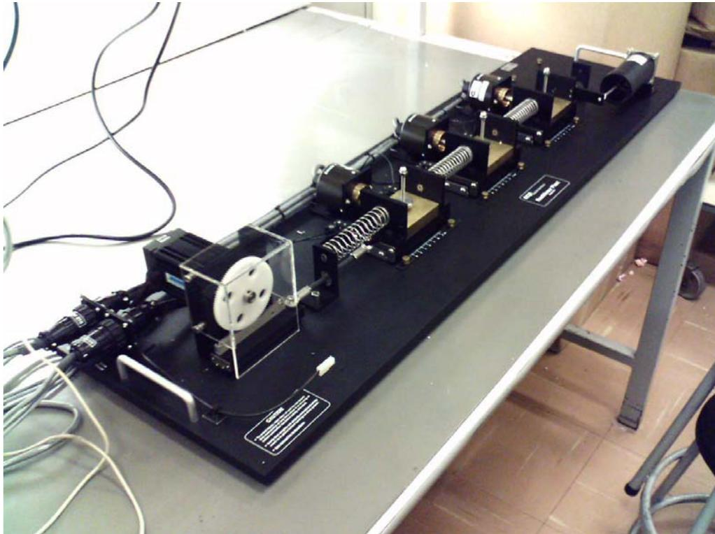
**Figura 9** - Sistema Massa Mola e Amortecedor (MANUAL ECP).
