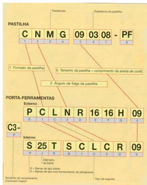
Figura 2 – Estrutura da norma ISO para pastilhas intercambiáveis e porta-ferramenta – parte I (adaptado da referência [15])
