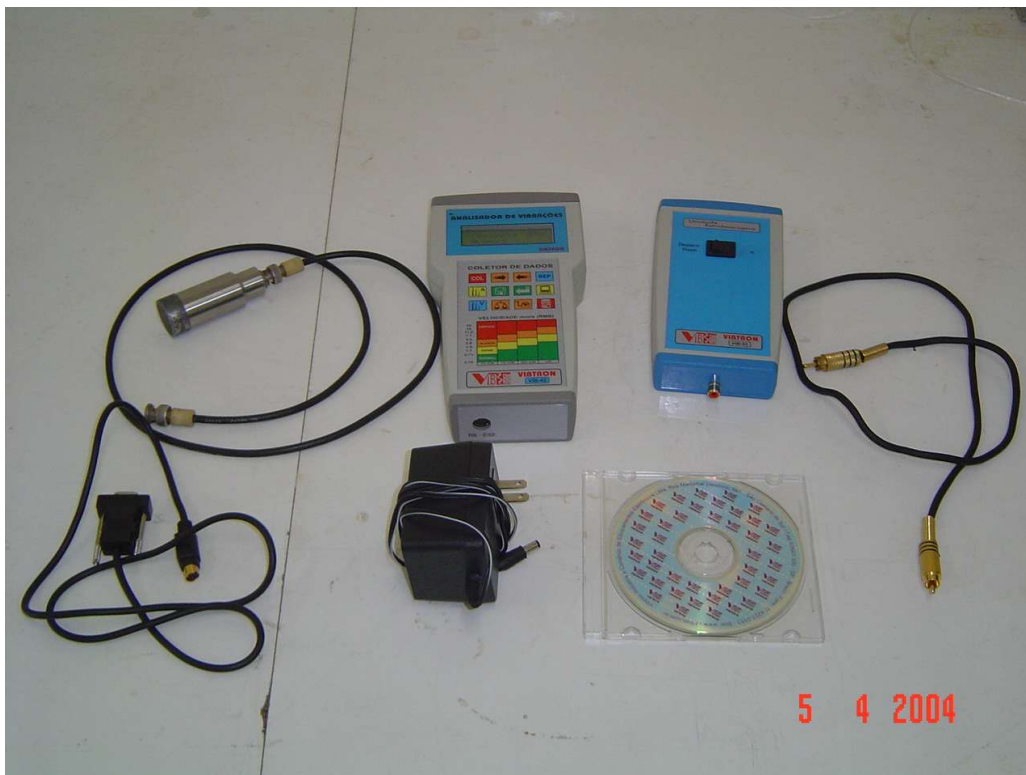
Figura 3.2 – Equipamentos e acessórios utilizados para o balanceamento (VIB-42)
