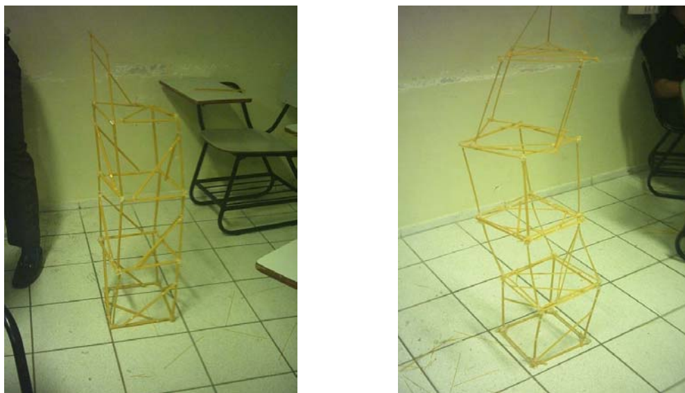
Figura 2 – Estruturas modeladas com falta de conceituação espacial.
