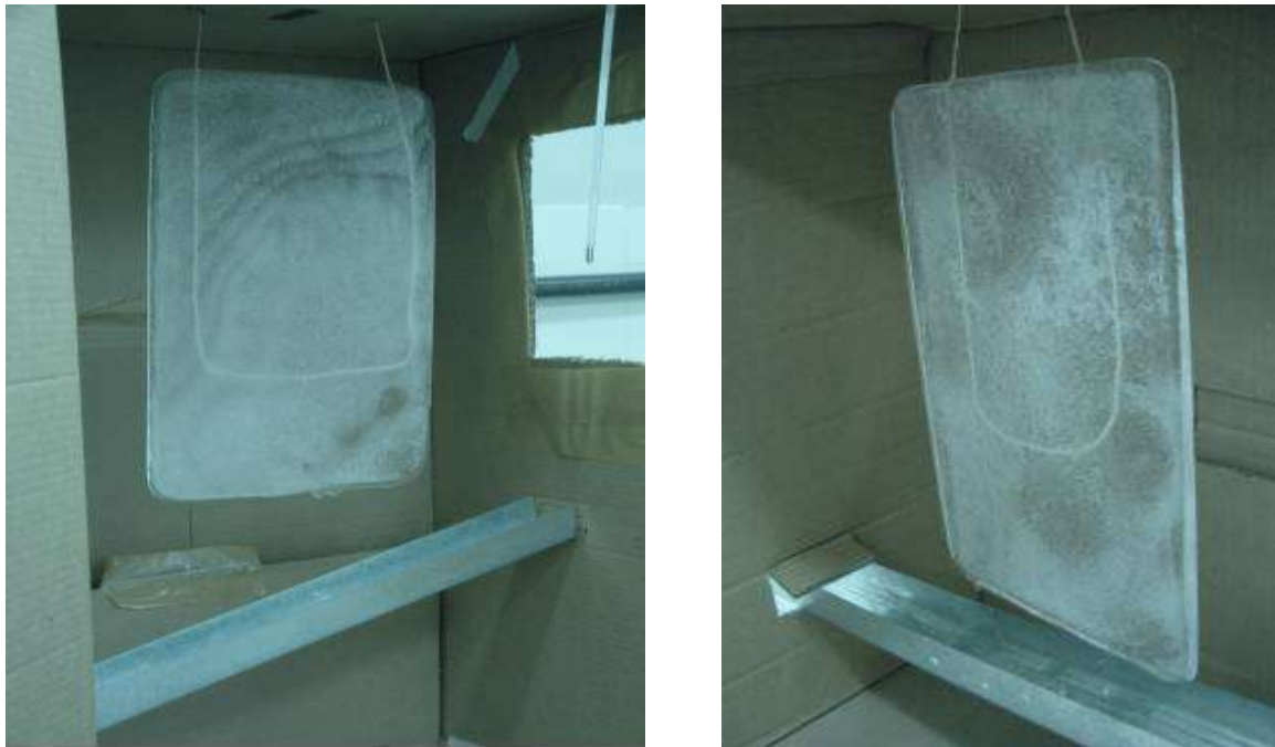
Figura 2 – Foto do experimento de convecção natural na superfície de uma placa de gelo suspensa em ar estagnado.
