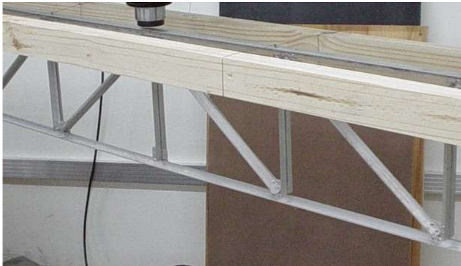
Figura 3 – Detalhe das uniões da treliça de alumínio
