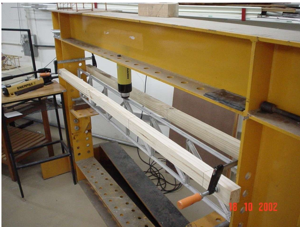
Figura 6 – Modo de flambagem com vários travamentos
