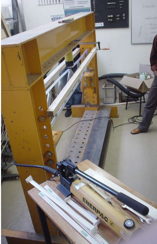
Figura 5 – Modo de flambagem se nenhum travamento
