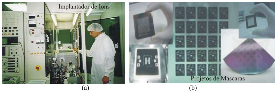
Fig. 3 - Sala limpa do CCS: (a) Implantador de Ions; (b) Desenho de Máscaras.
