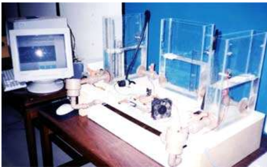
Figura 1.1 – (a) Sistema de nível de líquidos (b) Configuração do processo como dois sistemas
