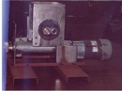
Figura 1. Triturador construído em escala piloto.
