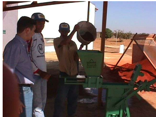
Figura 3: Aluno pesquisador acompanhando a transferência de tecnologia da fabricação de tijolo de solo-cimento em João Dourado. Foto: Moscatelli, 2003.
