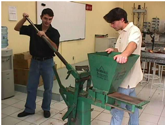
Figura 2: Alunos pesquisadores fabricando tijolo de solo-cimento no Laboratório de Solos da UPM. Foto: Vizioli, 2003.
