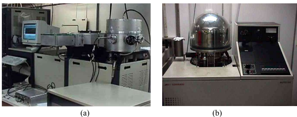
Fig. 3 - Sala limpa do LSI : (a) Plasma etching; (b) Evaporador para metalização.
