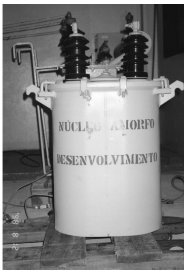
Figura 1 – Transformador monofásico com núcleo de liga amorfa.
