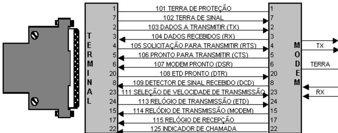
Figura 2 – Conector DB-25 e os principais sinais de uma interface digital
