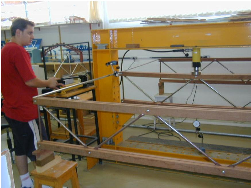
Figura 6 - Ensaio para pesquisas em sistemas mistos aço - madeira. Fonte: (PRAVIA et al, 2002)
