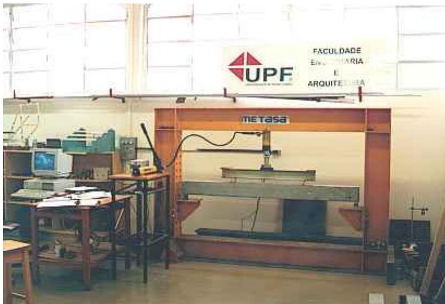
Figura 4 - Ensaio de viga de concreto armado
