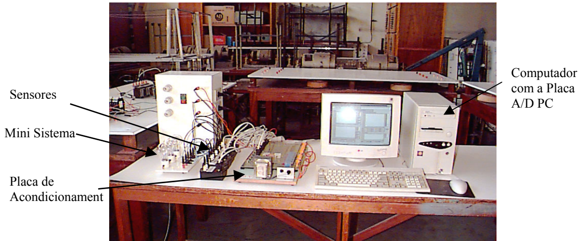
Figura 2 - Foto do sistema completo com sensores, placa de acondicionamento de sinais e micro PC com placa A/D.
