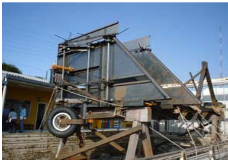
Protótipo de máquina colheitadeira de ramos de amora (inérita) para criação do bicho da seda
