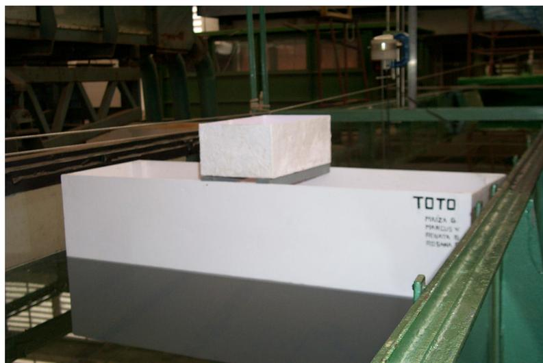
Figura 4: Modelo do corpo paralelo de petroleiro com reservatório de água projetado para absorver movimentos de jogo.
