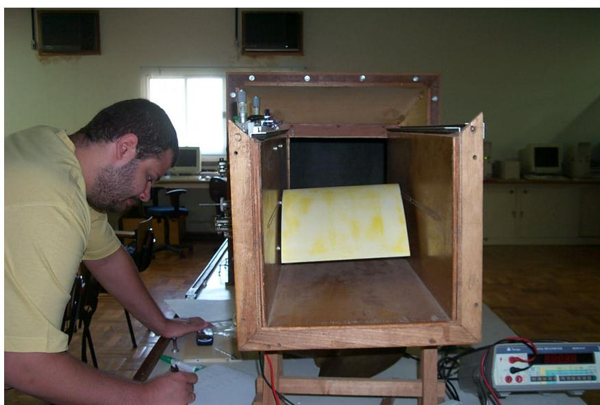
Figura 6: Teste com a asa projetada no túnel de vento do Laboratório de Hidrodinâmica.
