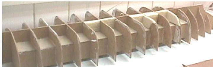
Figura 2: Primeira fase de construção dos modelos.
