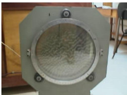
Figura 13 - Sistema de montagem para filtros de um polariscópio de transmissão da UFU
