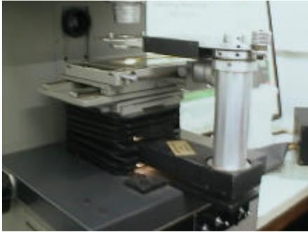
Figura 9 - Polariscópio adaptado a um Projetor de Perfis
