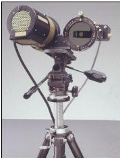
Figura 7 - Polariscópio de Reflexão 030 da Measurements Group,2000.
