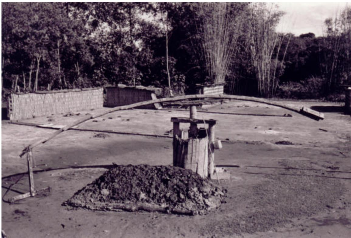
Fotografia 1: a pipa utilizada na olaria do Sr. José Cerilo (ao lado pode se observar um amontoado de argilas sobre a vala na qual as argilas são colocadas para “curtir”)
