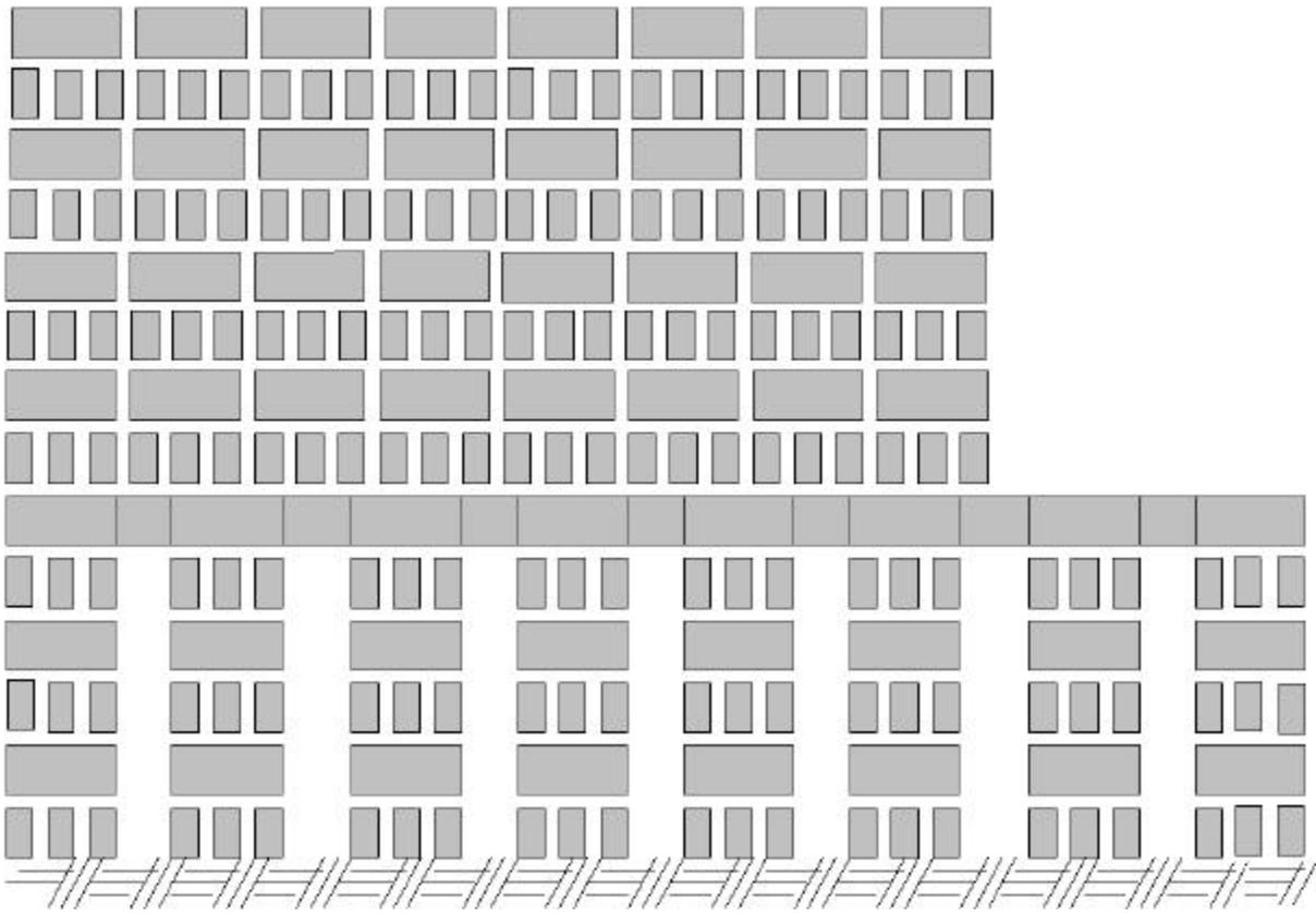
Figura 4 – Vista lateral de um forno sem a “capa”
