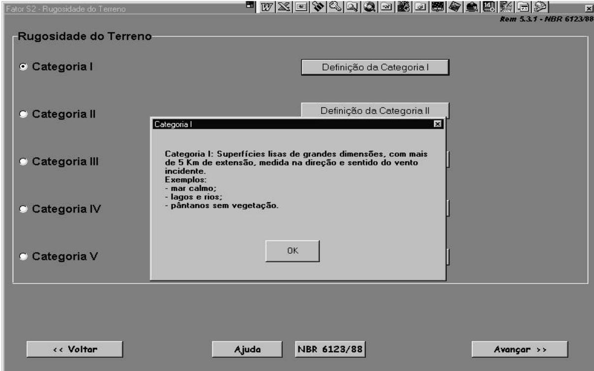
Figura 7. Definição das categorias de rugosidade do terreno, fator S2.
