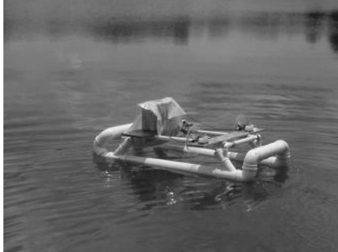
Figura 10. Instantâneo de uma trajetória para teste de integração de sensores, atuadores e *software* de navegação e guiagem.
