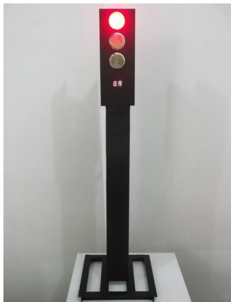
Figura 2(Semáforo- Estrutura Metálica) Placa com Led's de 3mm Fonte: Autores do Projeto
